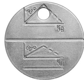
Bei mehrsträngigen Anschlagseilen wird ein Traglastanhänger angebracht, auf dem Seildurchmesser und die entsprechenden Traglasten eingeprägt sind.
