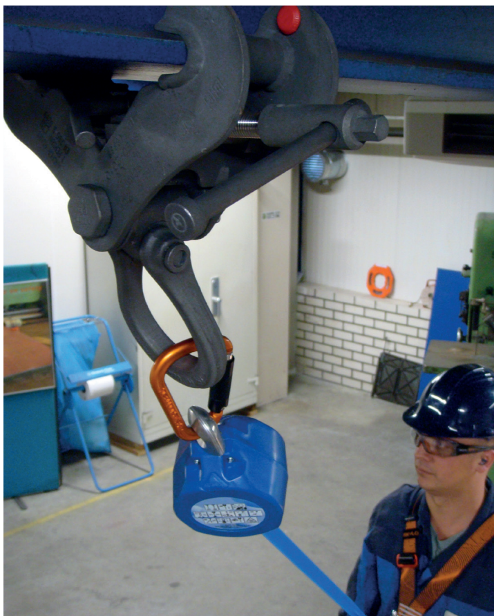
IPTKUM für PSA - Anschlagpunkt nach EN795
